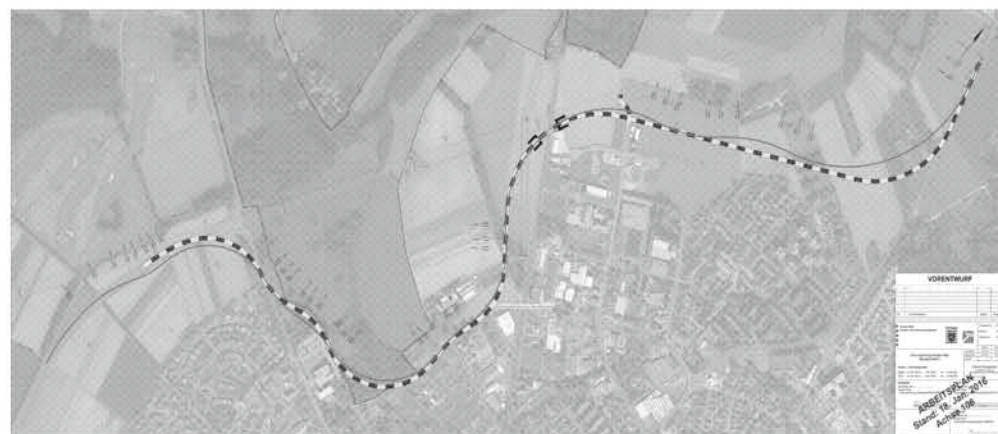
Übersichtslageplan zu Bauabschnitt 3 von Hessen Mobil: Die schwarz-weiße Linie stellt die Vorzugsvariante aus der Voruntersuchung dar, ist also nur eine grobe Linienplanung. Die zweite Linie ist eine aktuelle Lösung, sie wird aber im weiteren Planverlauf noch weiter optimiert.
